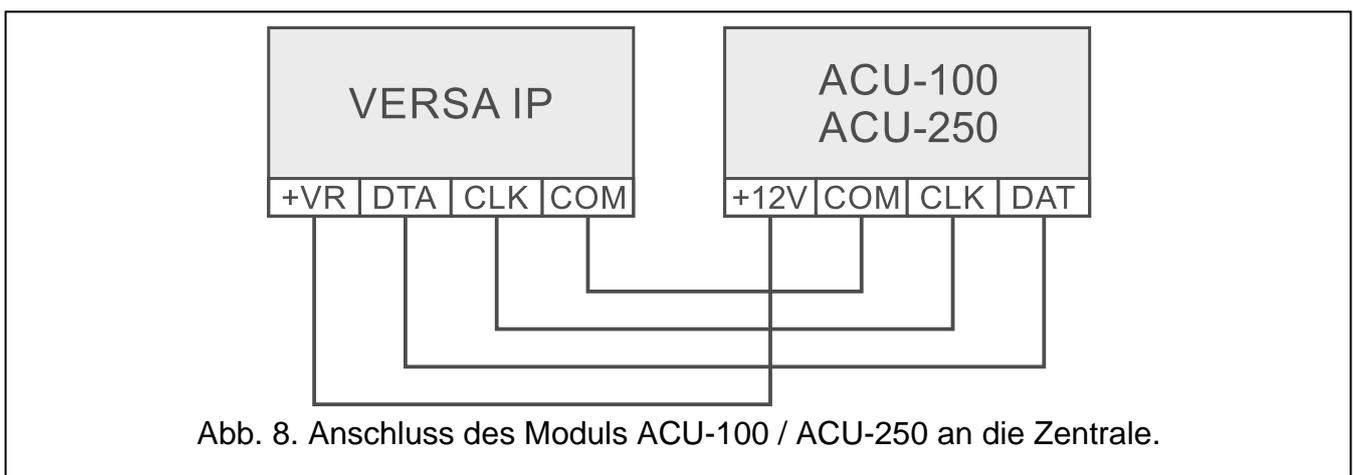
Abb. 8. Anschluss des Moduls ACU-100 / ACU-250 an die Zentrale.
