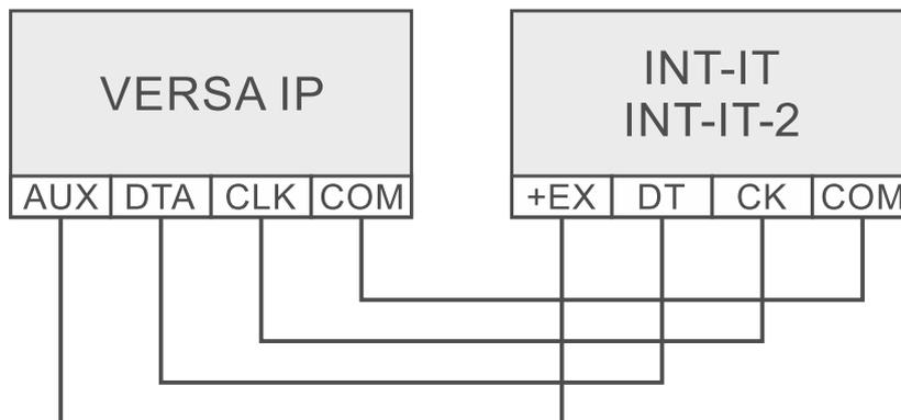
Abb. 14. Anschluss des Moduls INT-IT / INT-IT-2 an die Zentrale.
