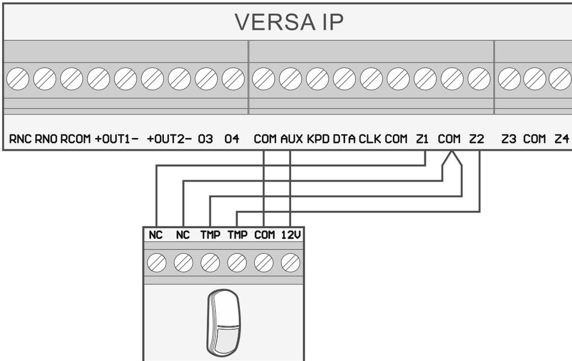
Abb. 17. Beispiel für den Anschluss eines NC-Melders (den NO-Melder schließen Sie identisch an).
