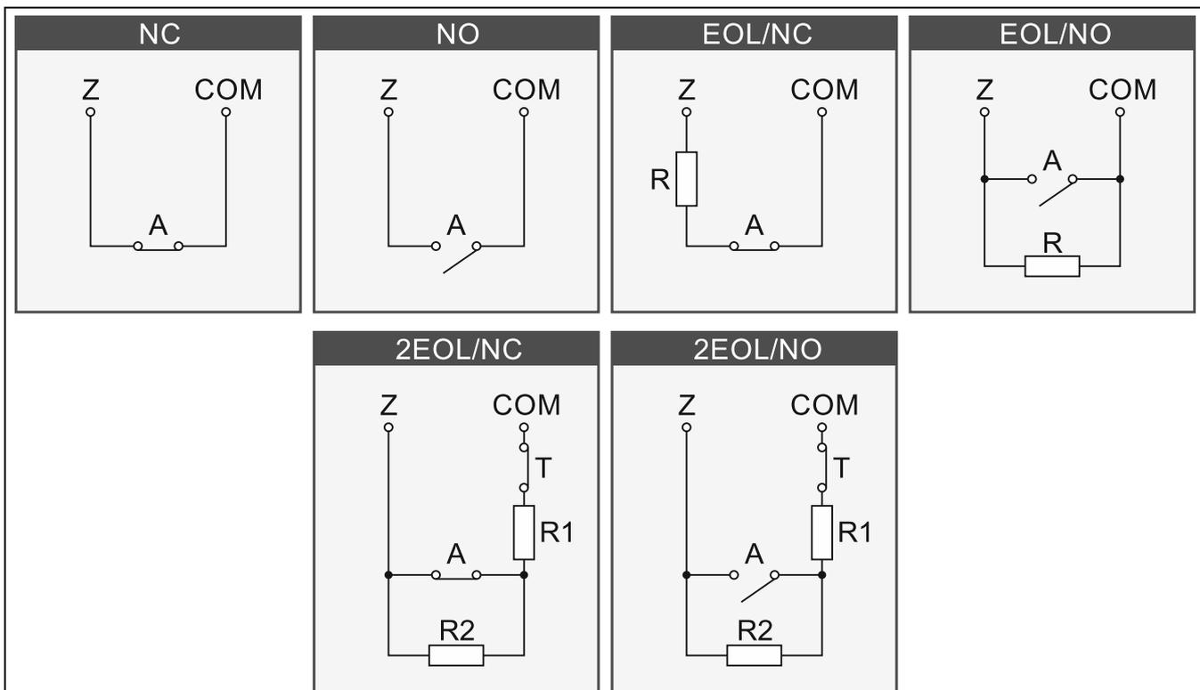
Abb. 16. Anschluss der Melder an die Meldelinien. Die Ausgänge des Melders sind mit Buchstaben gekennzeichnet: A - Alarm, T – Sabotage.  $R=R1+R2$ .
