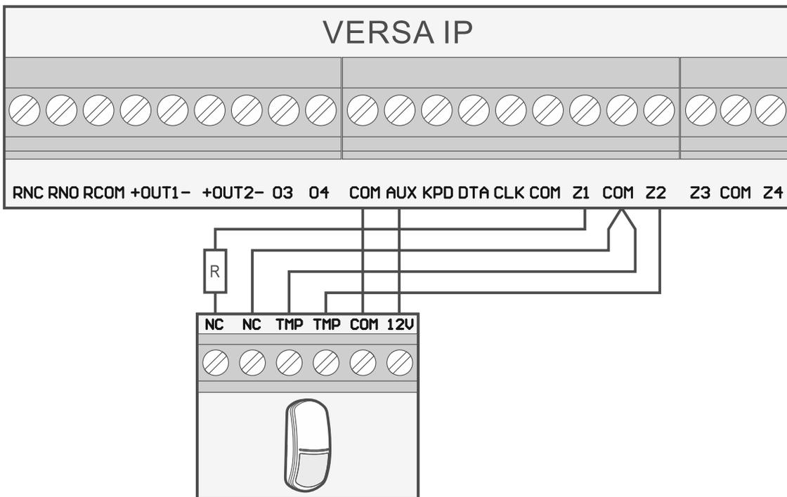
Abb. 18. Beispiel für den Anschluss eines NC-Melders in der Konfiguration EOL.
