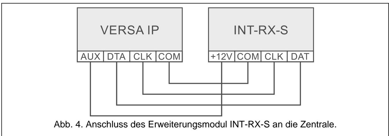
Sie können an die Zentrale ein Erweiterungsmodul INT-RX oder INT-RX-S anschließen. Es ermöglicht die Zuweisung den Benutzern der Handsender 433 MHz (bis zu 30 Handsender). Im Erweiterungsmodul muss die Adresse 7 (07h) eingestellt sein.
