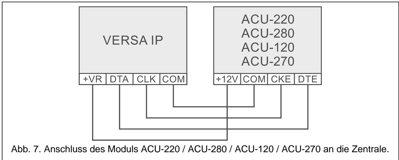
Abb. 7. Anschluss des Moduls ACU-220 / ACU-280 / ACU-120 / ACU-270 an die Zentrale.
