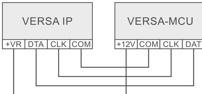
Abb. 6. Anschluss des Funkbasismoduls VERSA-MCU an die Zentrale.
