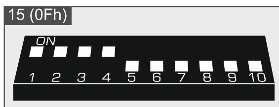
Abb. 12. Einstellung der DIP-Schalter im Modul INT-O.
