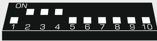
Abb. 12. Einstellung der DIP-Schalter im Modul INT-E.
