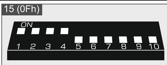
Abb. 12. Einstellung der DIP-Schalter im Modul INT-O.
