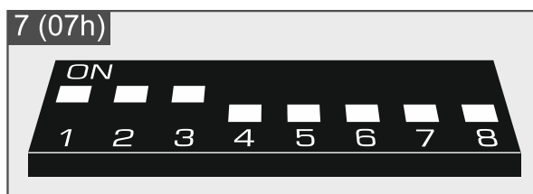
Abb. 8. Einstellung der DIP-Schalter im Modul INT-RX-S.
