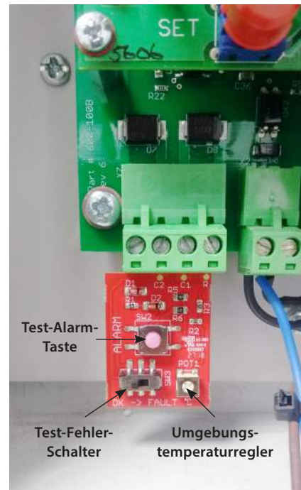
Abbildung 12: In der Steuereinheit installierte analoge Testplatine
