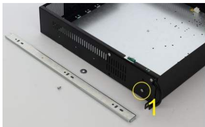
Entfernen Sie die erste M4-Schraube aus dem ARAS-Gehäuse
