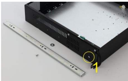
Entfernen Sie die erste M4-Schraube vom ARAD-Gehäuse
