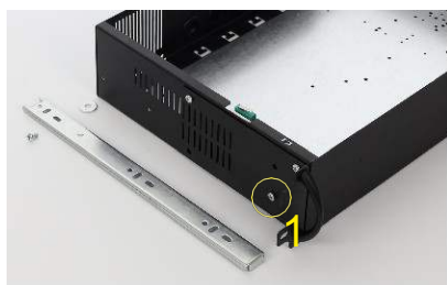
Entfernen Sie die erste M4-Schraube vom ARAD-Gehäuse
