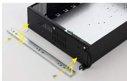
Befestigen Sie die Schieber mit zwei Schrauben am ARAD-Gehäuse (vergessen Sie nicht die Distanzscheibe unter der zweiten Schraube)
