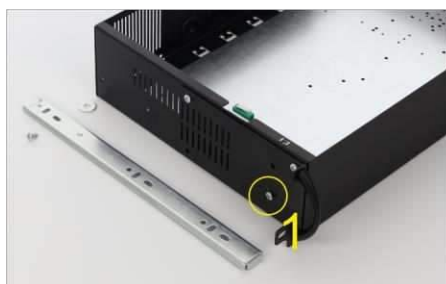
Entfernen Sie die erste M4-Schraube vom ARAD-Gehäuse
