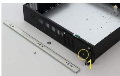
Entfernen Sie die erste M4-Schraube vom ARAD-Gehäuse
