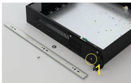
Entfernen Sie die erste M4-Schraube vom ARAD-Gehäuse
