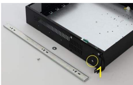
Entfernen Sie die erste M4-Schraube vom ARAD-Gehäuse
