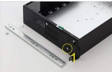
Entfernen Sie die erste M4-Schraube vom ARAD-Gehäuse
