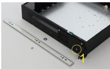
Entfernen Sie die erste M4-Schraube vom ARAD-Gehäuse
