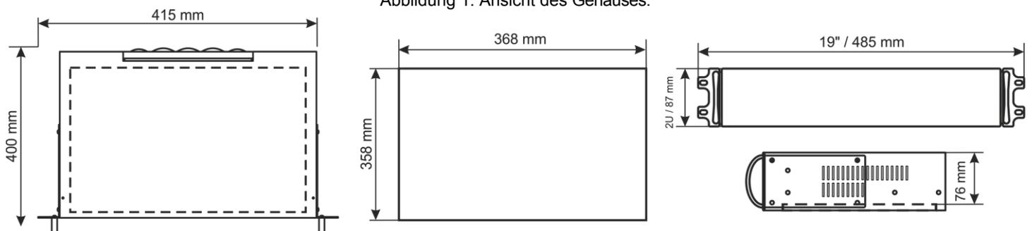
Abbildung 2. Abmessungen.
