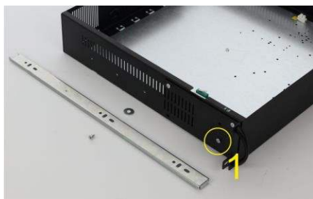
Entfernen Sie die erste M4-Schraube vom ARAD-Gehäuse
