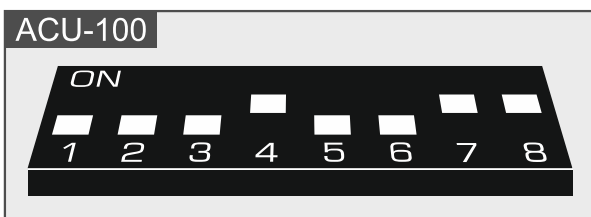
Abb. 9. Einstellung der DIP-Schalter in den ABAX 2 / ABAX Funkbasismodulen.
