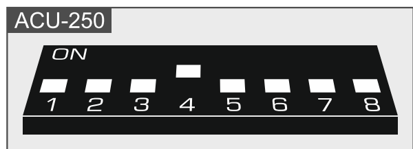
Abb. 9. Einstellung der DIP-Schalter in den ABAX 2 / ABAX Funkbasismodulen.
