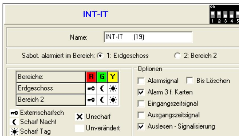
Abb. 19. Programm DLOADX: Konfiguration des Moduls zur Steuerung der Bereiche.
