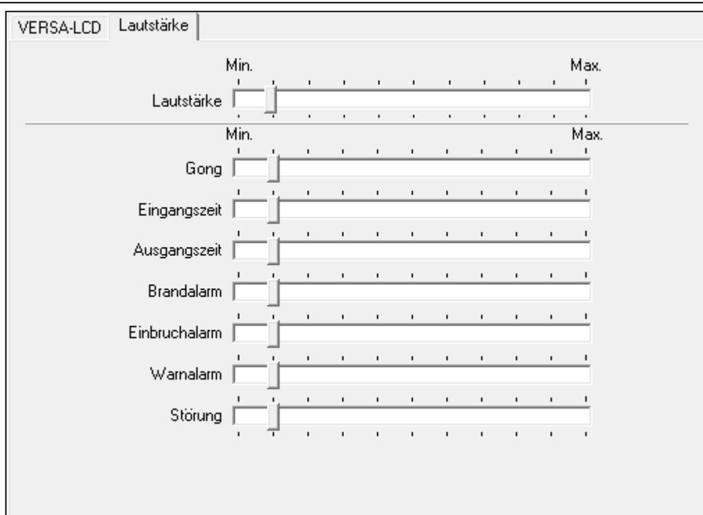
Abb. 14. Programm DLOADX: Konfiguration der Lautstärke im Bedienteil.
