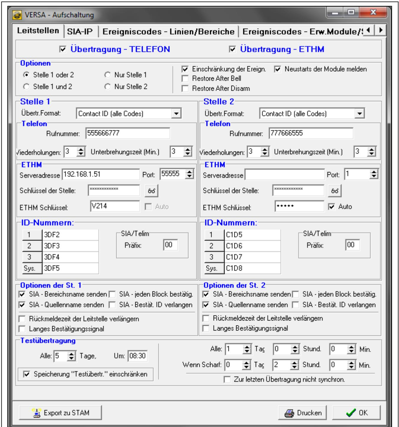
Abb. 21. Programm DLOADX: Registerkarte „Leitstellen“ im Fenster „VERSA – Aufschaltung“.
