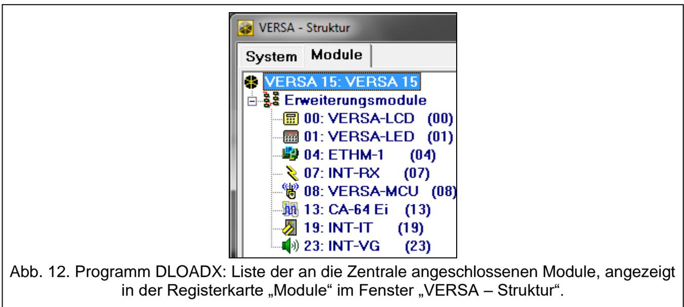
Abb. 12. Programm DLOADX: Liste der an die Zentrale angeschlossenen Module, angezeigt in der Registerkarte „Module“ im Fenster „VERSA – Struktur“.
