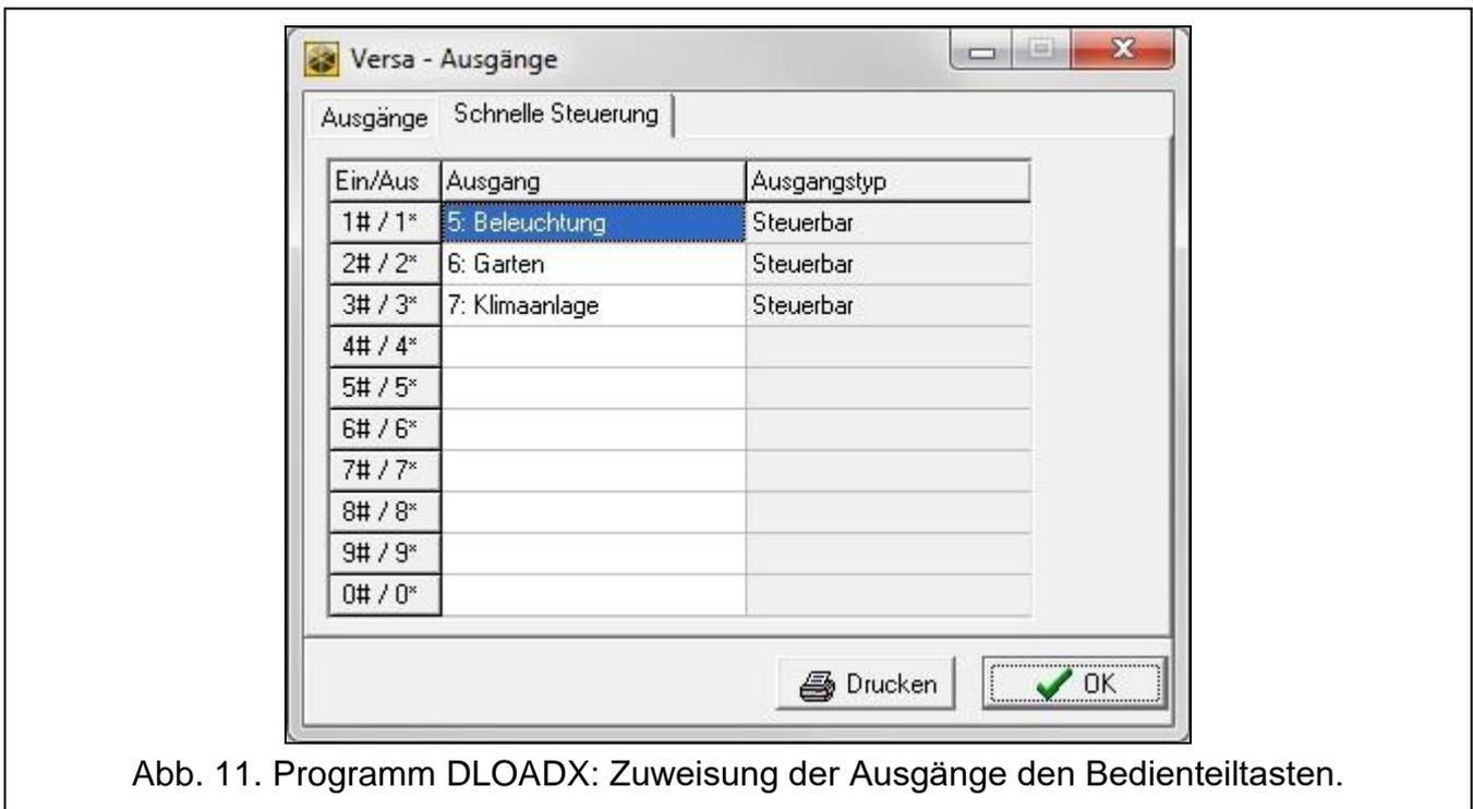
Abb. 11. Programm DLOADX: Zuweisung der Ausgänge den Bedienteiltasten.
