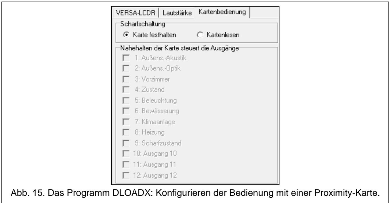
Abb. 15. Das Programm DLOADX: Konfigurieren der Bedienung mit einer Proximity-Karte.
