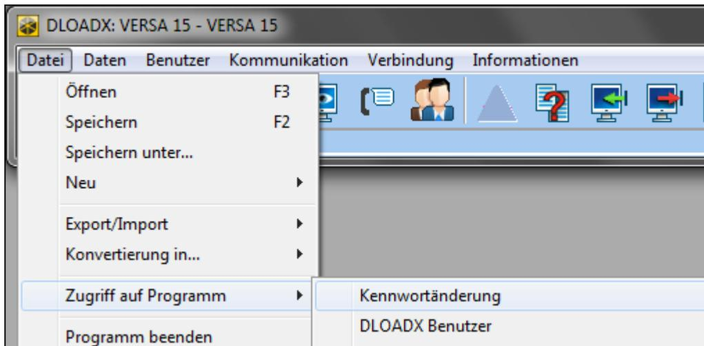
Abb. 5. Verfahren zur Änderung des Zugangscode zur Software DLOADX.
