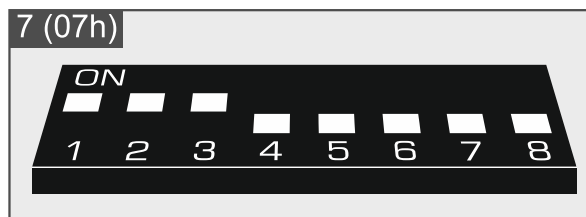
Abb. 9. Adresseinstellung im Erweiterungsmodul INT-RX-S / INT-RX.
