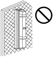
Pfosten nicht an einer Stelle montieren, an der keine ausreichende Stabilität gewährleistet werden kann.
