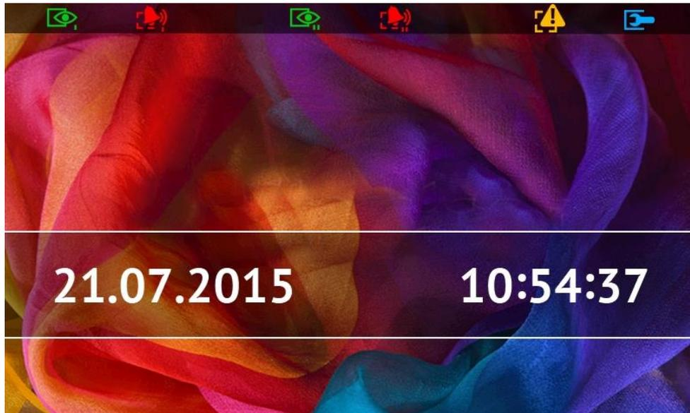
Die Statusanzeige wird 60 Sekunden nach der letzten auf dem Display ausgeführten Tätigkeit angezeigt, es sei denn, dass das Tastaturfeld aktiviert ist (siehe: S. 13). Wenn das Tastaturfeld angezeigt ist, wird die Statusanzeige später oder überhaupt nicht angezeigt (z.B. wenn das Servicemenü aktiv ist).
