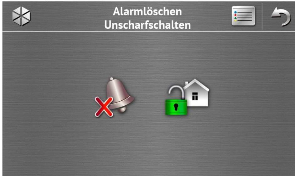
Das Fenster „Alarmlöschen / Unscharfschalten“ wird nach dem Antippen des Icons
