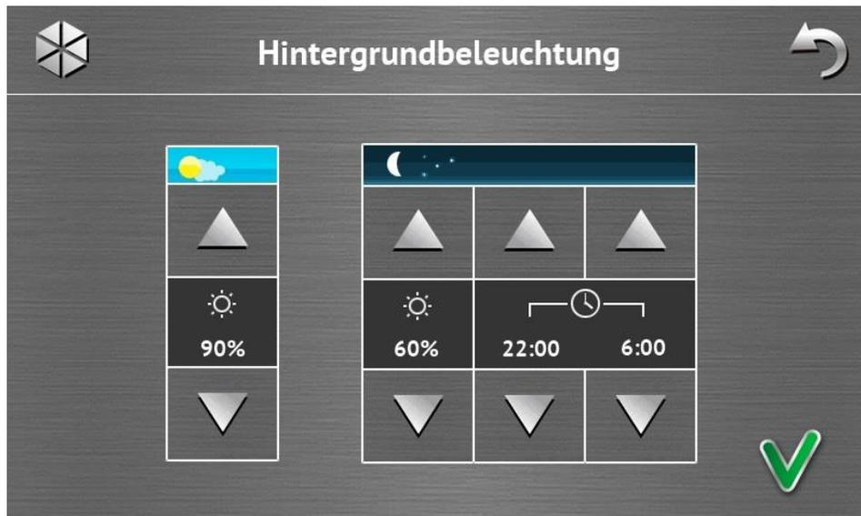
Die Intensität der Hintergrundbeleuchtung kann zwischen 10-100% eingestellt werden. Für definierte Nachtstunden kann eine andere Beleuchtungsintensität eingestellt werden.
