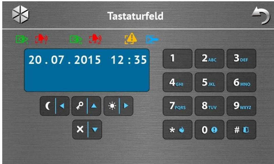
Das Tastaturfeld ermöglicht die Bedienung und Parametrierung des Alarmsystems genauso wie über ein LCD-Bedienteil mit dem Textmenü. In den Parametrierungs- und Benutzeranleitungen der Alarmzentrale wurde beschrieben, wie solch ein Bedienteil verwendet werden soll (diese Anleitungen sind in elektronischer Form unter [www.satel.eu](http://www.satel.eu) verfügbar).
