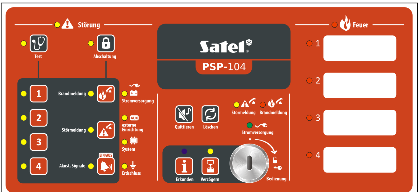
Abb. 9. Front des Bedienfeldes PSP-104.
