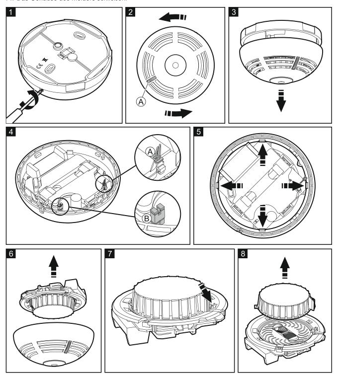
15. Den Test-/Löschknopf (mit A in der Abbildung 2 gekennzeichnet) drücken und halten. Der Alarm soll ausgelöst werden.
