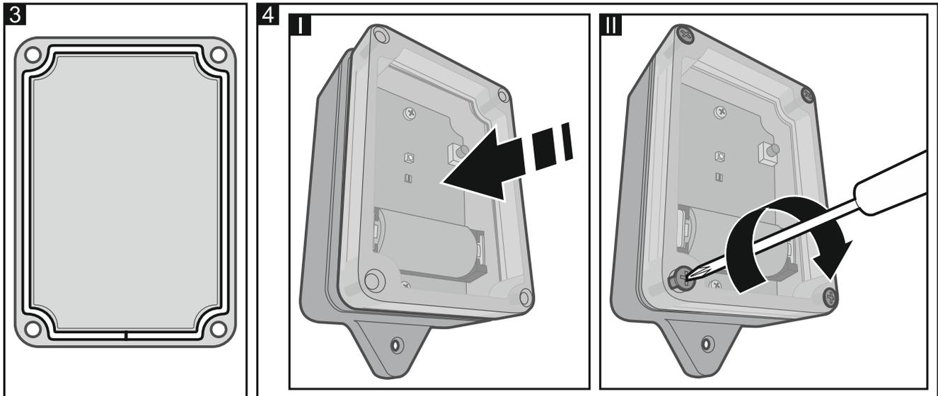
6. Befestigen Sie das Gehäuseunterteil mit Schrauben an der Montagefläche. Wählen Sie Dübel aus, die für den Typ der Montagefläche entsprechend sind (andere für Beton oder Ziegel, andere für Gips u. ä.).
