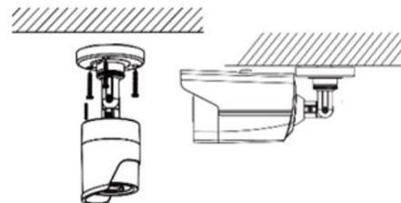
Abbildung 2-2 Kamera befestigen
