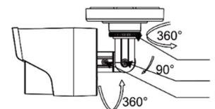
Abbildung 2-3 3-Achsenausrichtung
