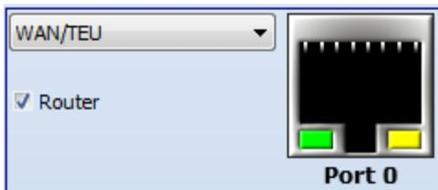
Um UMTS nutzen zu können, muss das Wegemodul TEU 1 eingesetzt werden. Dieses ist als eine Art UMTS-Router anzusehen und wird über eine LAN-Buchse mit dem LAN-Port 0 beim TAS-Link III verbunden.
