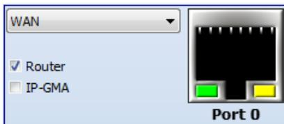
Die Funktionalität "WAN" (Wide Area Network) ermöglicht es, das TAS-Link III direkt an ein bestehendes Netzwerk inkl. Router anzuschließen.
