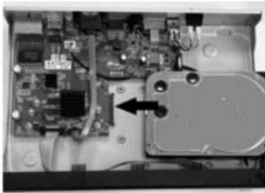
Abbildung 2-2 Festplatte anschließen
