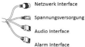
Abbildung 1-2 Überblick über den Kabelbaum
