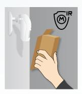
OPAL Pro ist mit einer aktiven IR-Abdecküberwachung ausgestattet, so dass der Melder u.a. Versuche erkennt, die Linse mit Farbe oder Lack zu übermalen oder mit Stoffen verschiedener Dicke, Textur und Farbton zu verdecken.
