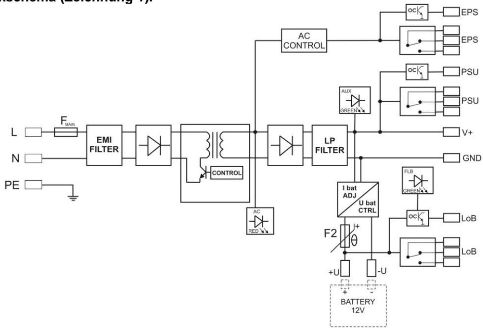
Abbildung 1: Blockschema des Netzteils.
