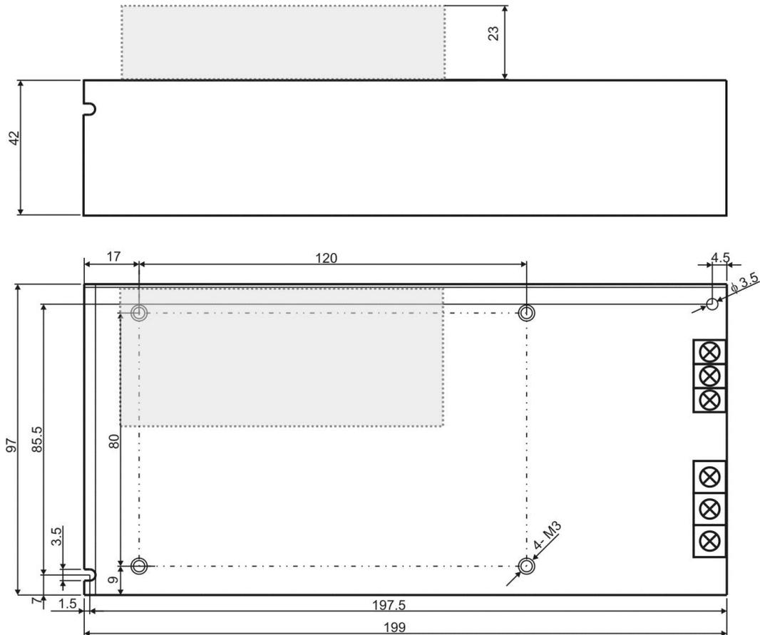
Abbildung 3. Mechanische Ansicht des Netzteils.
