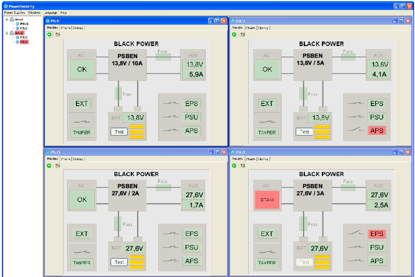
Abb. 27. Hauptsteuerung des Programms „Power security“.
