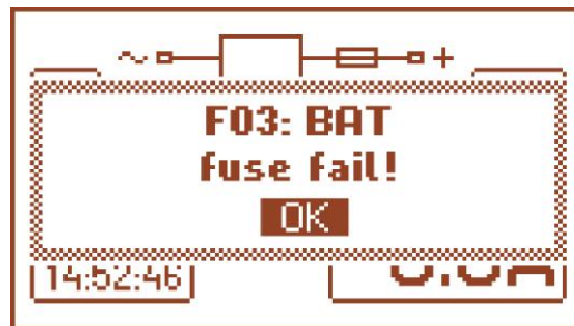
Abb. 9. Die Meldung, die das Brennen der Sicherung am AUX- Ausgang signalisiert.
