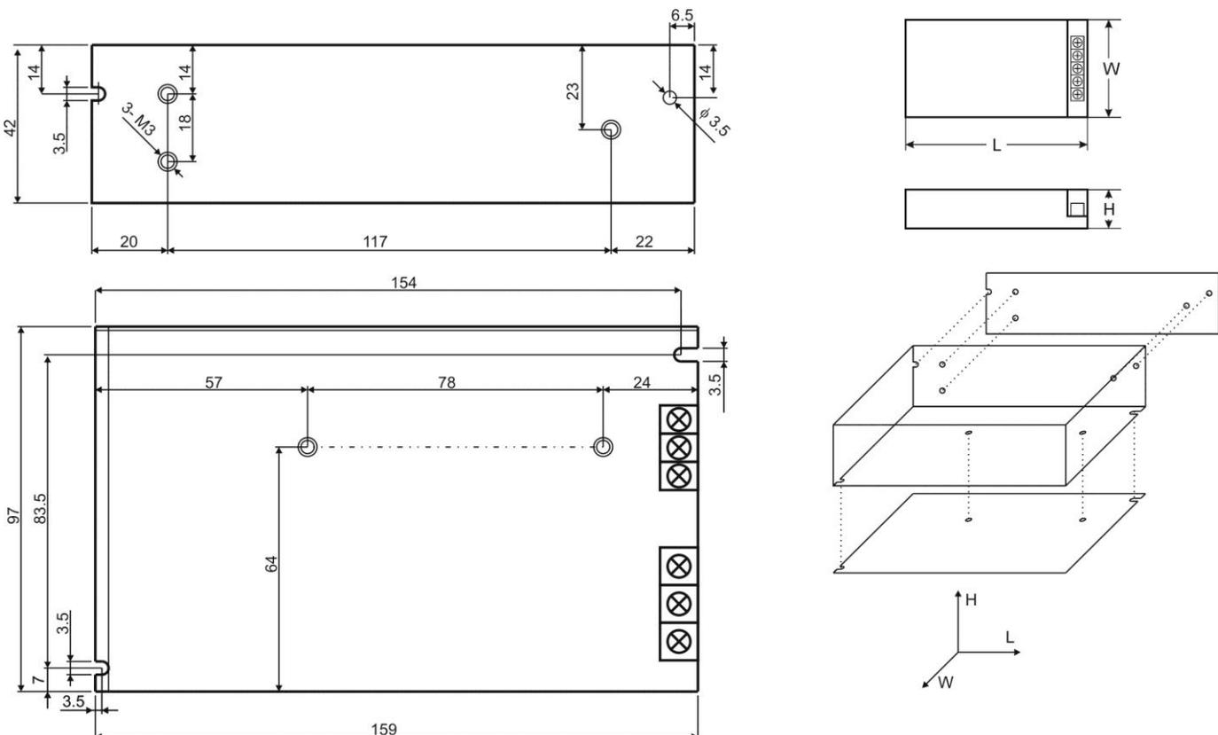
Abbildung 2. Mechanische Ansicht der Speiseleitung.
