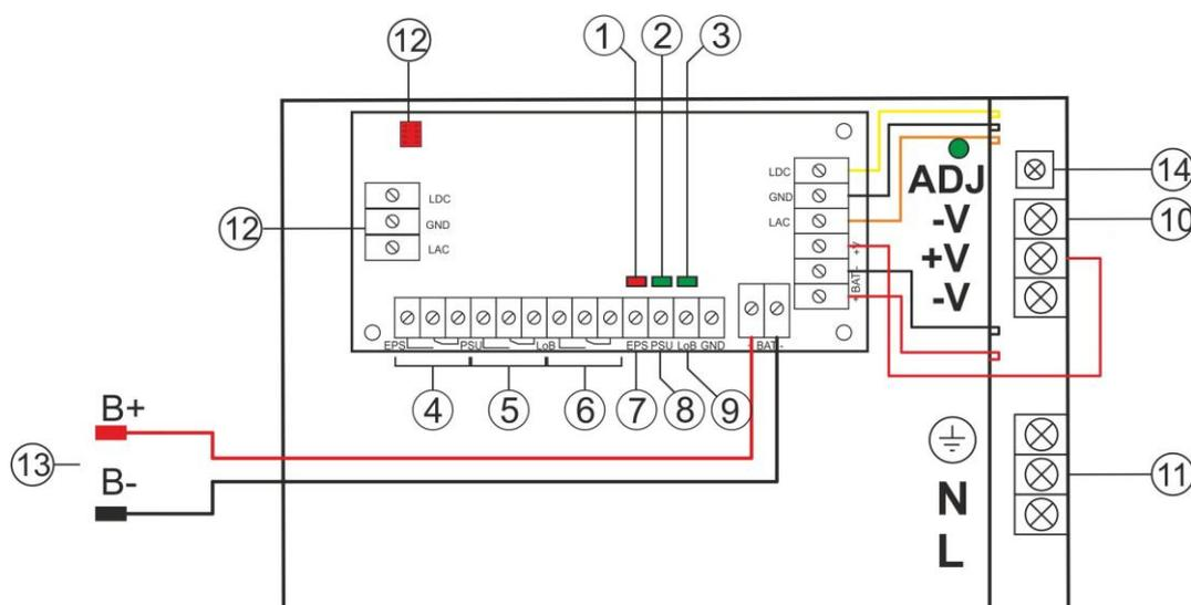
Abbildung 3. Ansicht der Speiseleitung mit dem Modul MPSB24.
