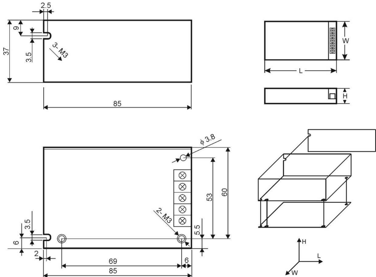
Abbildung 2. Mechanische Ansicht des Netzteil
