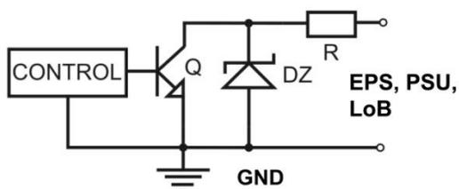
Abbildung 3. Schema des Ausgangs vom Typ OC.
