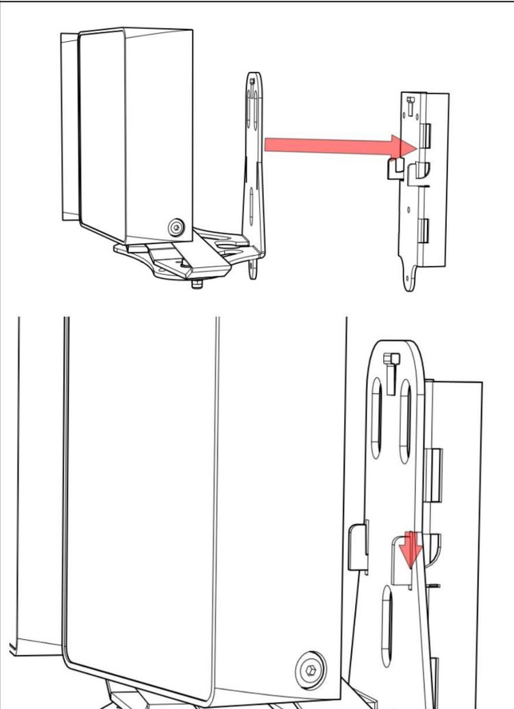
12. Hängen Sie die Beleuchtungseinheit in die Universaladapterplatte ein
