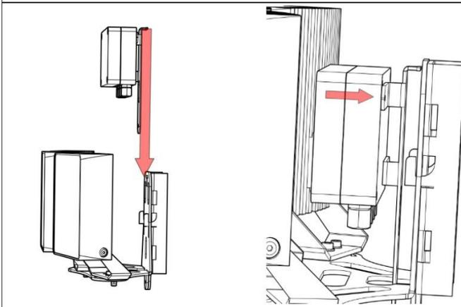
17. (z.B. Einfach) Montieren Sie die Verteilerdose an ihrem Platz, indem Sie die Nut ausrichten und hineindrücken.
