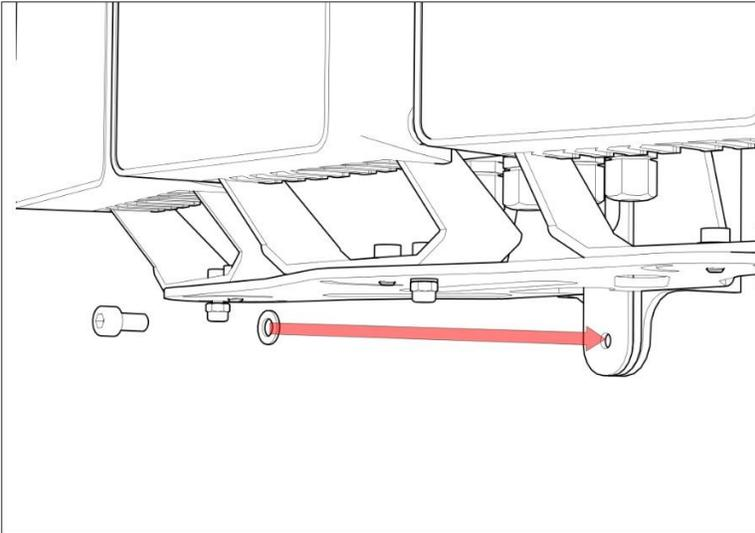
19. Führen Sie die Befestigungsschraube (ISO4762 M5X10) mit der Scheibe (ISO7089 5.3) ein.
