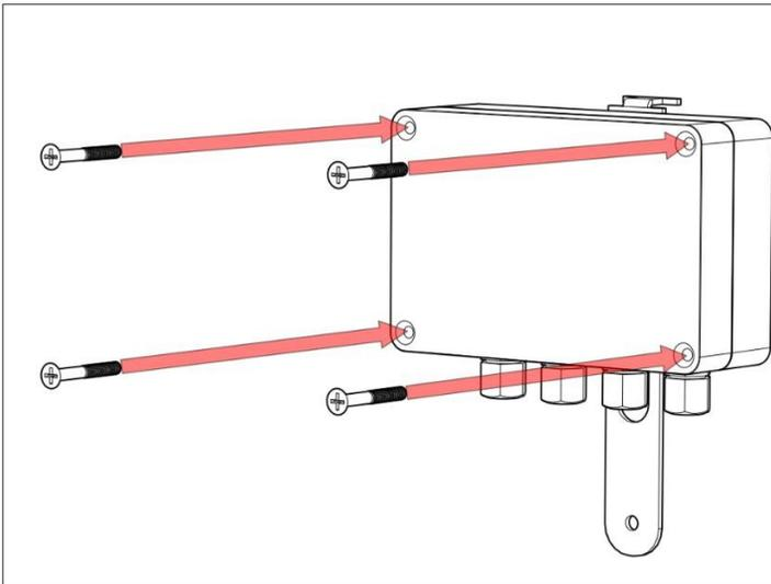
16. (z.B. Einfach) Prüfen Sie die Dichtung, bevor Sie die Schrauben des Deckels anziehen (4Stk. M4x30).
