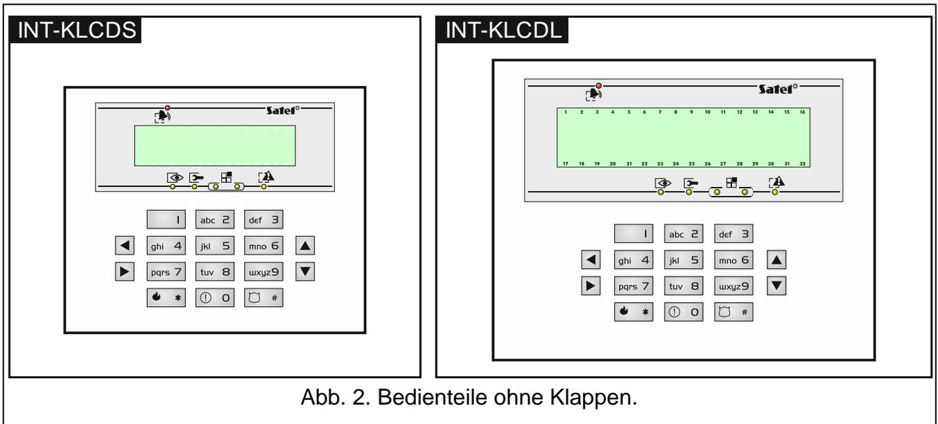
Abb. 2. Bedienteile ohne Klappen.
