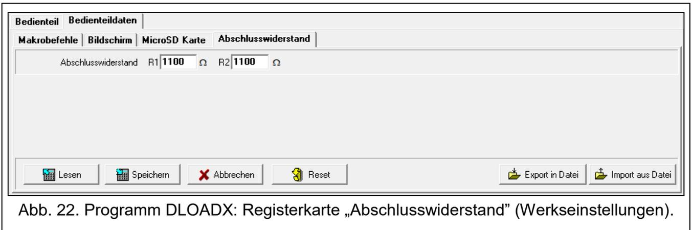
Abb. 22. Programm DLOADX: Registerkarte „Abschlusswiderstand“ (Werkseinstellungen).
