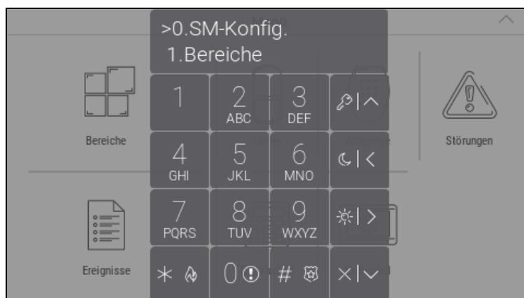
Abb. 11. Tastaturfeld mit angezeigtem Servicemenü.
