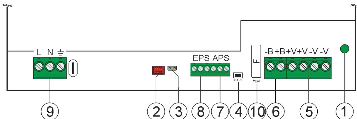
Abb. 2b. Ansicht des Moduls des Netzteils (Modelle 12V10A, 24V5A)
