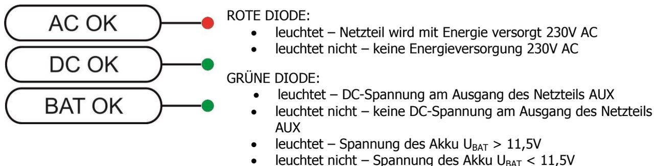
Darüber hinaus wurde das Netzteil mit 3 LED-Dioden an der PCB-Platte ausgestattet:
