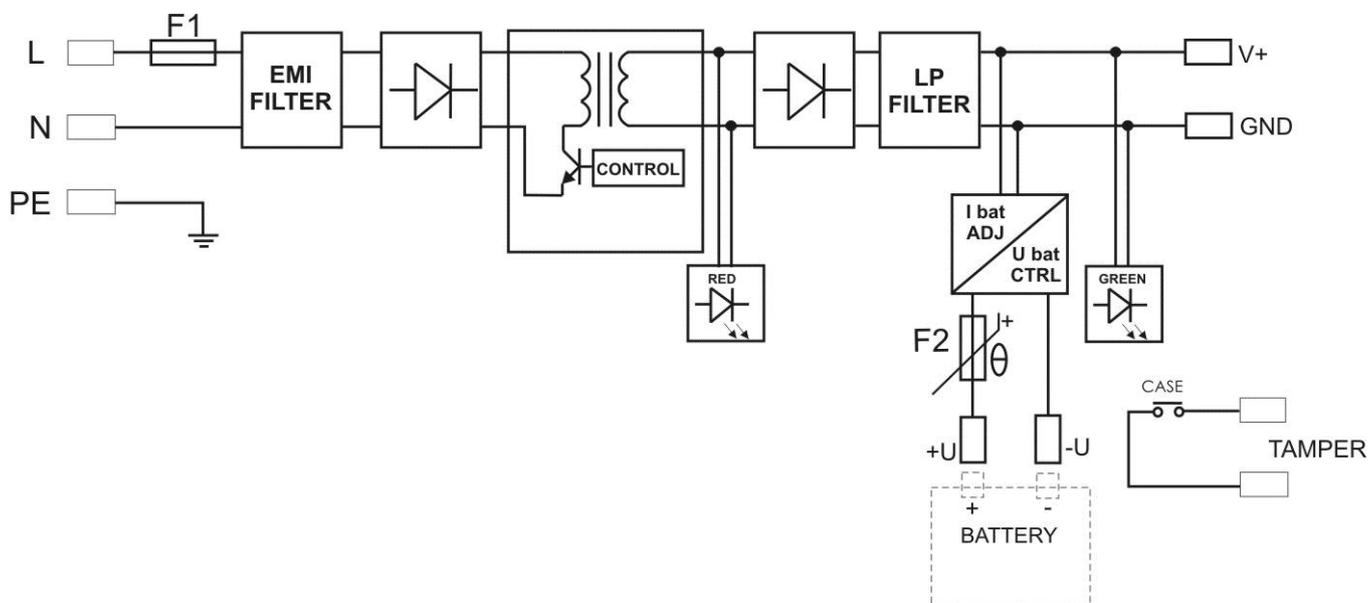
Bild 1. Schaltplan Netzteil.
