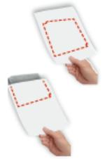
2. **Feuer** – Decken Sie den Reflektor mit einem nicht reflektierenden Gegenstand langsam bis **70%** ab, um ein Feuer / Rauch zu simulieren. Nach 10 Sekunden sollte der **firebeam** Alarm registrieren und die **rote LED** wird blinken.
