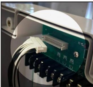
**Wichtig:** Stellen Sie sicher, dass der Stecker korrekt gesteckt wird.
