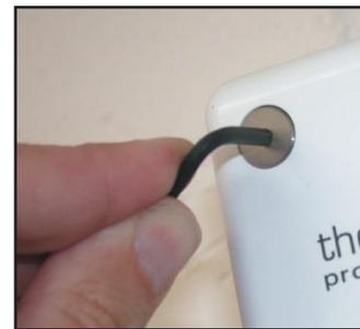
Schrauben Sie das Melderoberteil mit dem beiliegenden 3mm Innensechskant-schlüssel fest.
