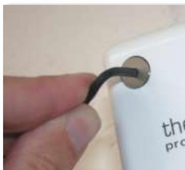
Schrauben Sie das Melderoberteil mit dem beiliegenden 3mm Innensechskant-schlüssel fest. Melderoberteil behutsam aufsetzen, quetschen Sie nicht die Kabel ein.
