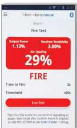
Drücken Sie **Test starten**, um einen Brand Alarm Test durchzuführen. Dies funktioniert durch Ausführen eines Testalgorithmus, um die Senderleistung zu senken. Der Empfänger sieht dies als Verdunkelung und löst nach unterschreiten der Alarmschwelle den Brand Alarm aus.
