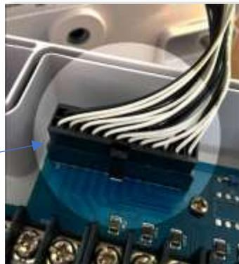
Um Schäden am Melderkopf zu vermeiden, nicht die Frontabdeckung am Kabel herunterhängen lassen.
