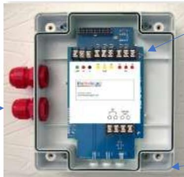
Anschlüsse zur BMZ (siehe allg. Anschlussbild). Kabel- und Anschlußkomponenten müssen unterhalb der Sockeloberkante bleiben!
