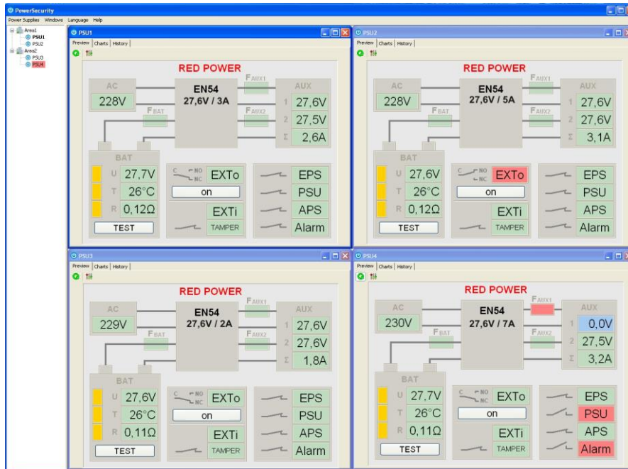
Abb. 21. Hauptpanel des Programms „Power security“.
