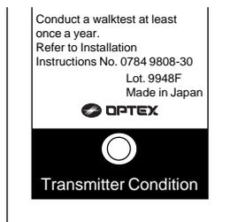
Nach erfolgter Montage und Einstellung der BX-100 PLUS nebst Zubehörteilen ist unbedingt ein Gehetest/Funktionskontrolle durchzuführen.
