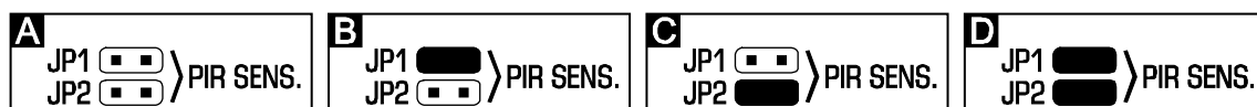
Abb. 2. Einstellung der Empfindlichkeit des Melders (A – niedrige, B und C – mittlere, D – hohe Empfindlichkeit) [ – Pins kurzgeschlossen; – Pins geöffnet].
