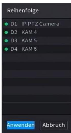
4. Ziehen Sie mit gedrückter Maustaste das Kamerabild an die gewünschte Position und lassen die Maus wieder los.
