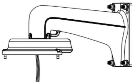
Abbildung 2-4 Montagesockel befestigen
