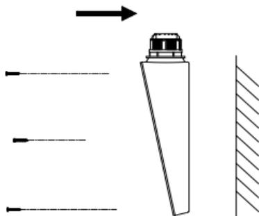
Abbildung 2-5 Montagesockel befestigen
