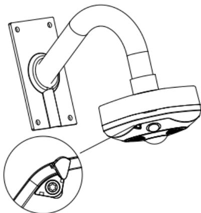
Abbildung 2-14 Anziehen der Feststellschraube an der Kameraabdeckung
