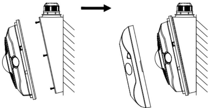
Abbildung 2-7 Kameragehäuse und Abdeckung befestigen
