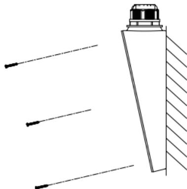
Abbildung 2-6 Schrauben bis zur Hälfte eindrehen
