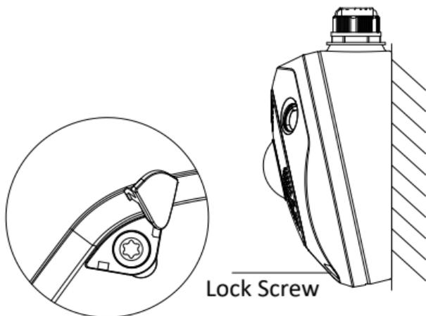
Abbildung 2-8 Anziehen der Feststellschraube
