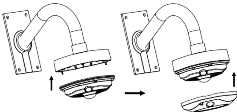
Abbildung 2-13 Kameragehäuse und Abdeckung befestigen
