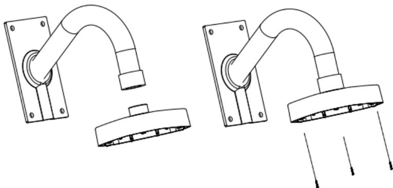
Abbildung 2-12 Halterung befestigen
