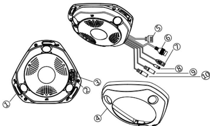
Abbildung 1-2 Öffnen der Fisheye-Kamera
