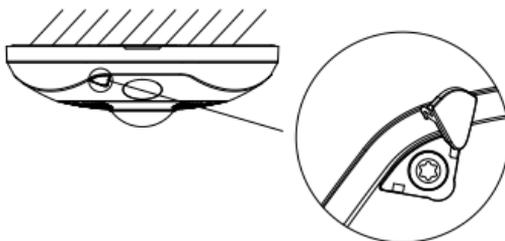
Abbildung 2-4 Anziehen der Feststellschraube
