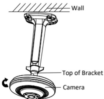
Abbildung 2-18 Kamera befestigen
