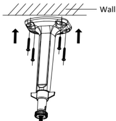
Abbildung 2-17 Halterung befestigen
