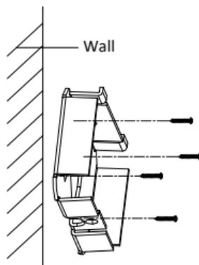
Abbildung 2-15 Montagesockel befestigen
