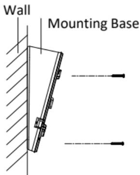
Abbildung 2-8 Montagesockel befestigen
