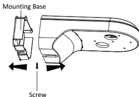
Abbildung 2-12 Halterung demontieren
