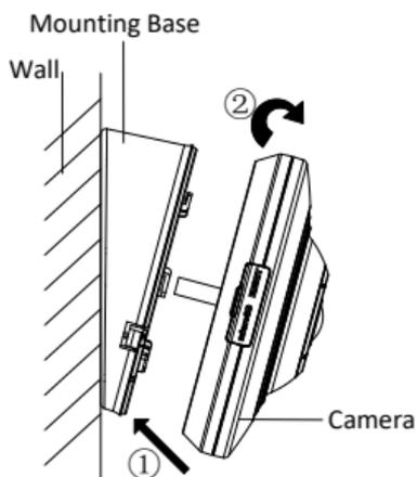
Abbildung 2-9 Kamera befestigen
