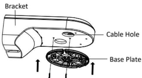
Abbildung 2-13 Montageplatte befestigen
