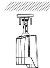
Abbildung 2-2 Kamera an der Decke befestigen
