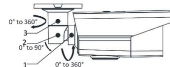
Abbildung 2-3 3-Achsenausrichtung
