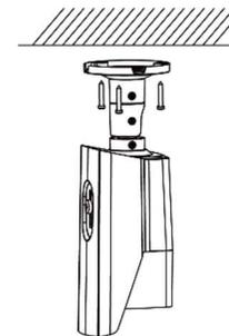
Abbildung 2-7 Befestigung der Kamera
