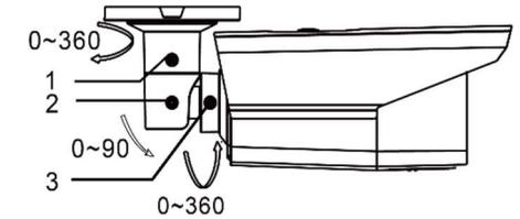
Abbildung 2-8 3-Achsenausrichtung
